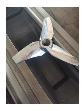
不锈钢搅拌器的功能简单的说就是提供搅拌过程所需要的能量和适宜的流动状以达到搅拌过程的目的。整个运动过程,是受到哪些因素的影响才能达到设备良好的运行效果呢?下文为大家讲解。不锈钢搅拌器整体运动这一过程是由运动着的叶轮产生,因此,叶轮的外形、尺寸、数量还有转速对搅拌器的功能形成了直接的影响。同时设备的功能发挥还与搅拌介质的物性和工作环境有关。另外,搅拌罐的形状、尺寸、挡板的设置情况、物料在罐中的进出方式都属于工作环境的范畴,以及搅拌器在罐内的安装位置,种种因素都能对搅拌器的功能形成不同程度的影响。搅拌功率是搅拌过程进行时需要的动力,包含搅拌器功率和搅拌作业功率,内涵不同却又有联系的。能够使搅拌器连续运转所需要的功率就是搅拌器功率。而把搅拌器使反应罐中的液体以比较好方式完成搅拌过程所需要的功率就是搅拌作业功率。
